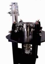
液氦/液氮/闭环低温探针台 可升级为UHV, ULV(超低振动)结构 可加电磁铁/超导磁体/矢量超导磁体
